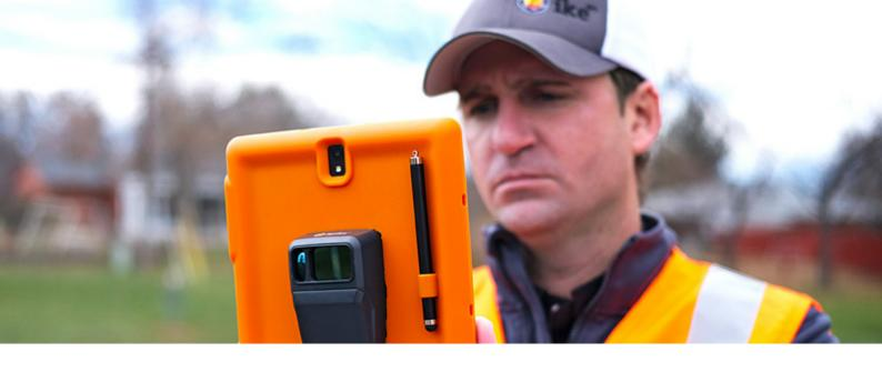
THE SPIKE LASER DEVICE CONNECTS WITH YOUR SMARTPHONE OR TABLET VIA BLUETOOTH. SPIKE'S LASER RANGEFINDER WORKS JOINTLY WITH YOUR SMARTPHONE OR TABLET'S CAMERA, GPS, COMPASS, AND CONNECTION TO THE INTERNET.
